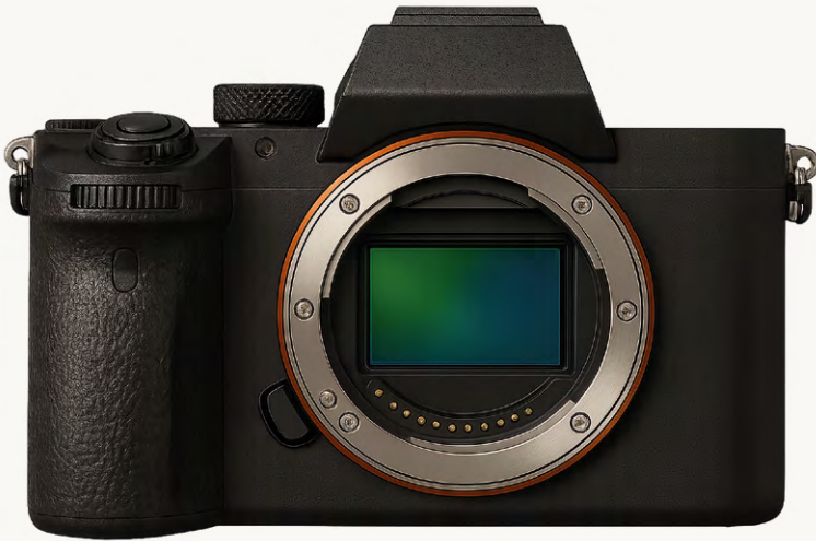
Abb. 2: Ein Kameragehäuse einer spiegellosen Kamera ohne Objektiv, auf der direkt der Sensor zu sehen ist.
